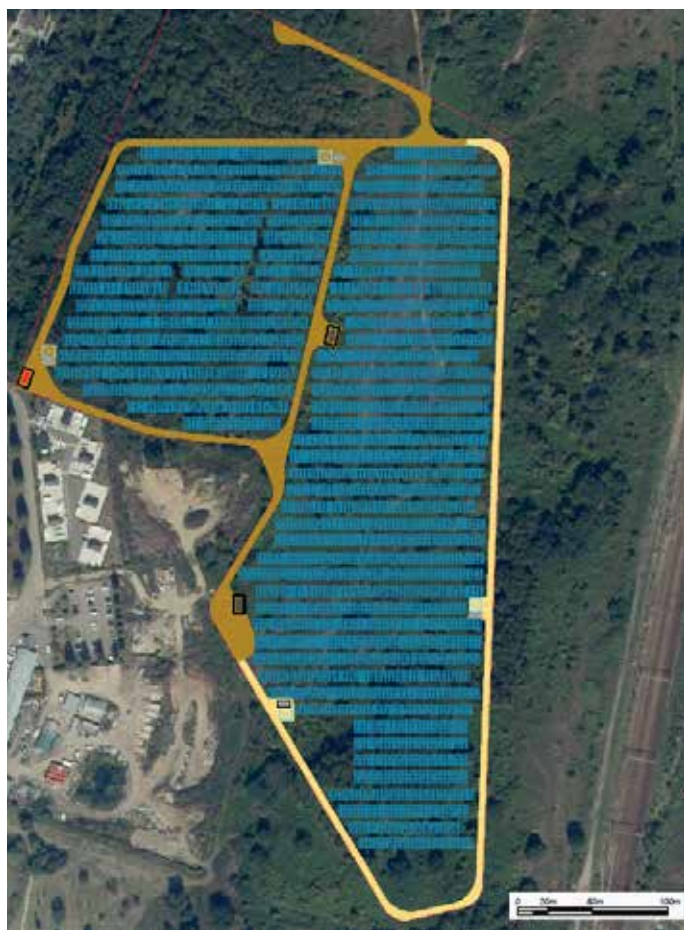
Schéma d'implantation de la centrale photovoltaïque
